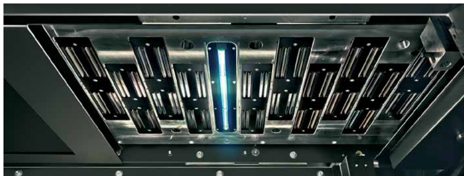
Печатная каретка с дополнительным LED излучением, вид снизу.
